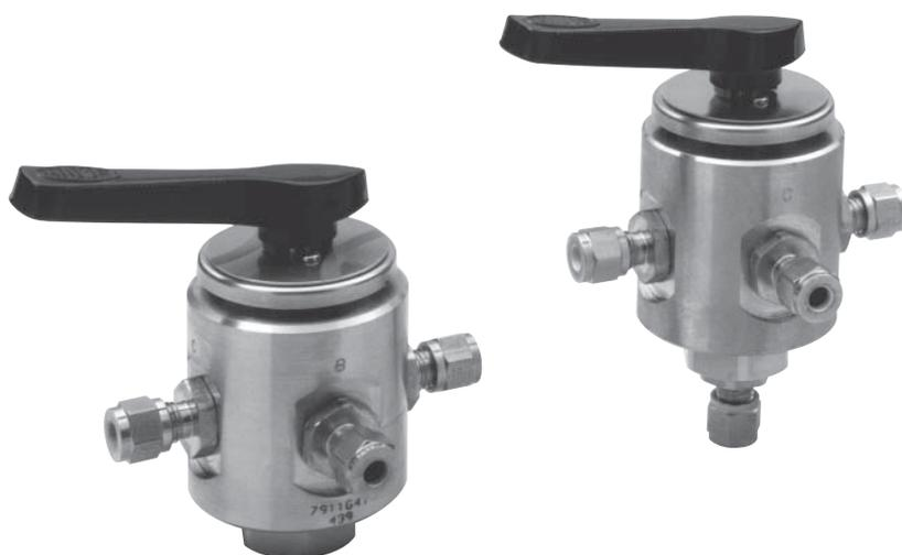
les vannes Multimite® 4 voies, ou vannes de sélection double, permettent l'utilisation de 2 circuits distincts, simultanément. La version 5 voies offre la même fonctionnalité que la version 3 voies mais avec 4 alternatives de circulation de débit.
