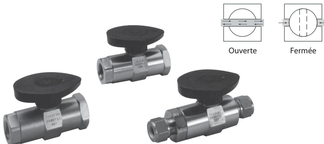
Les vannes à boisseau sphérique HOKE, 2 voies, séries Rotoball® 72, offrent un orifice de passage de 9,52mm. Elles possèdent un boisseau flottant associé à des sièges encapsulés et à une poignée plate et ovale, anti-rotation accidentelle, assurant fiabilité et étanchéité à long terme.
