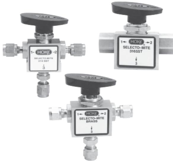
Les vannes à boisseau, Selectomite® 3 voies, fonctionnent à 180° pour permettre de dévier le débit d'une ligne vers une autre. La forme de la poignée indique la voie sélectionnée (le sens de passage du fluide); lorsque la poignée est en position perpendiculaire par rapport aux ports latéraux de sortie, la vanne est fermée.
