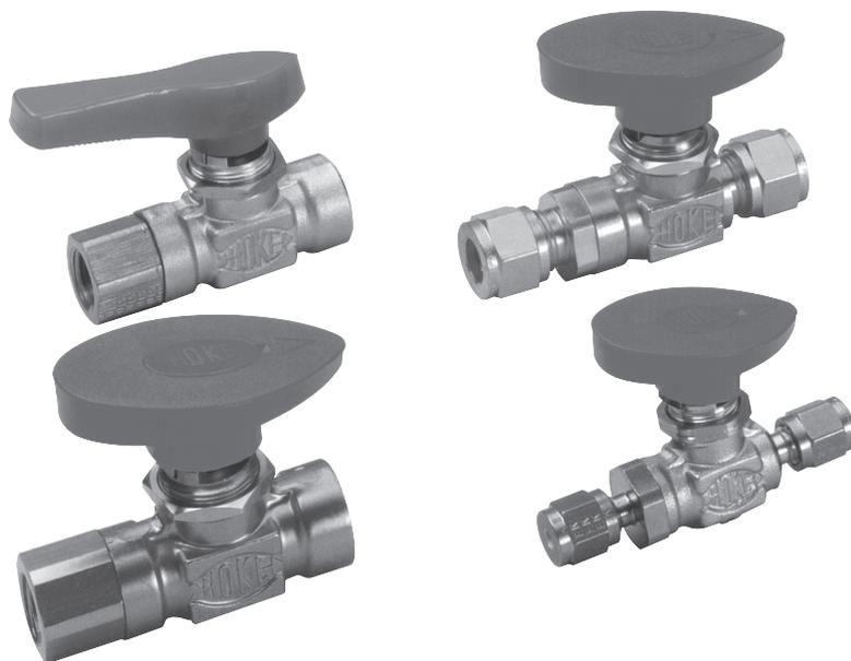
Utilisées pour service marche/arrêt rapide, avec contrôle visuel, les vannes à boisseau sphérique HOKE, 2 voies, sont dotées d'orifice de passage allant jusqu'à 6.35mm. Les vannes Flomite® intègrent un boisseau flottant associé à des sièges encapsulés, assurant étanchéité et longue durée de vie.
