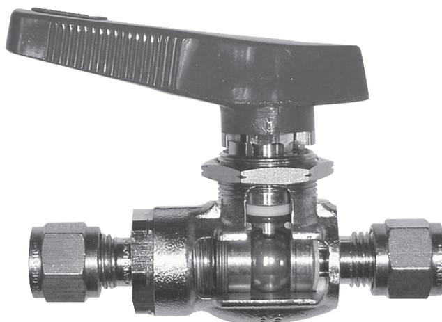
Les vannes à boisseau sphérique HOKE, séries DL/TL sont unidirectionnelles, et offrent plus de 100,000 cycles de manoeuvre sans fuite.\* Les séries 70 sont dotées de raccords soudés pour éviter une désolidérisation accidentelle du corps de la vanne. les séries DL/TL sont disponibles en versions laiton, inox 316, et Monel®, avec poignée de manoeuvre manuelle en standard, ou bien équipées d'un opérateur Space Savers™ HOKE pré-assemblé en usine.
