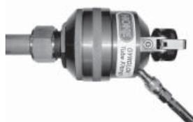
Écrou et bagues GYROLOK® sont assemblés dans l'outil hydraulique de pré-sertissage. La pompe à main est actionnée jusqu'à ce que le bras indicateur ne relâche.
