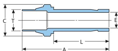
Ce type d'embout, avec empreinte de bague usinée, permet de raccorder bout à bout deux composants à embouts GYROLOK® de même diamètre.
