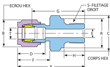
Ce type de composant GYROLOK® est prévu pour un montage sur une extrémité femelle au pas du gaz cylindrique, l'étanchéité étant ici garantie par l'adjonction d'un joint torique, ou plat, (non fourni avec le raccord).
