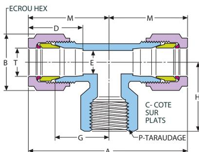
Ce type de Té, à droite et à gauche, des embouts de type GYROLOK® et, en son milieu, une sortie taraudée NPT femelle pour composant à extrémité mâle de même type.
