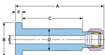
Les connecteurs bride GYROLOK® proposés par HOKE® permettent de réaliser, de manière simple et sûre, toute liaison entre le procédé et les instruments qui lui sont associés.
