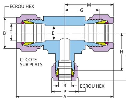
**TTTB:** Ce type de Té, à embouts GYROLOK®, permet de relier entre eux, trois tubes (même diamètre sur les deux connexions dans l'axe, diamètre plus petit sur la connexion latérale).
