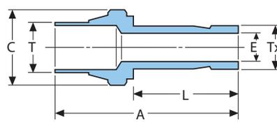
Ce type d'embout avec empreinte de bague usinée, permet de raccorder bout à bout deux composants à embouts GYROLOK® de diamètre différent.
