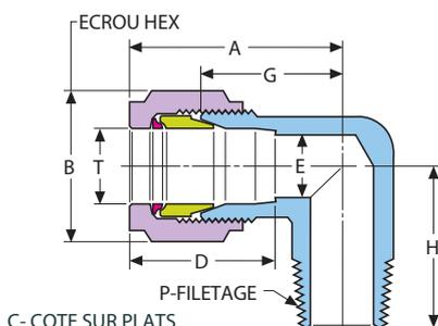
Ces type de coude permettent de convertir une extrémité de type NPT femelle en un embout GYROLOK®, pour montage d'un tube simple, tout en assurant un changement de direction de 90° ou 45° par rapport au premier axe.
