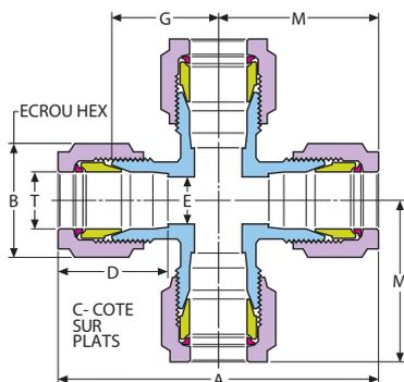
Ce type de croix permet de raccorder en un même point quatre tubes de même diamètre, grâce à ses embouts GYROLOK®.
