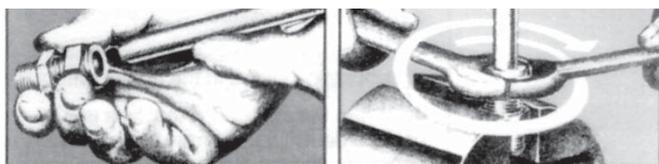
**Assemblage initial des bagues (bagues) sur le tube ou sur l'extrémité tube de raccords adaptateurs.**
