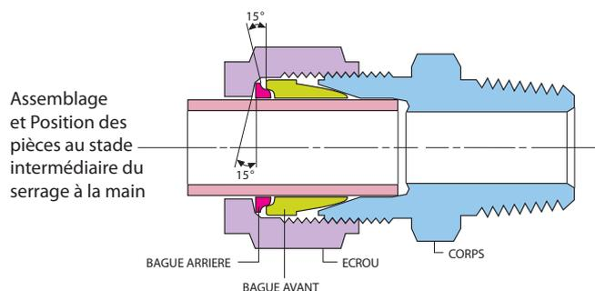
Assemblage et Position des pièces au stade intermédiaire du serrage à la main
