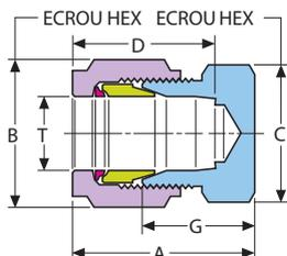
Ce type de bouchon permet d'obturer l'extrémité non utilisée d'un tube simple.
