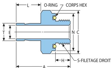
Ce type d'adaptateur est prévu pour être raccordé à un instrument présentant une connexion femelle. Il garantit une parfaite étanchéité lorsque les applications mettent en jeu aussi bien de hautes pressions qu'un vide poussé.
