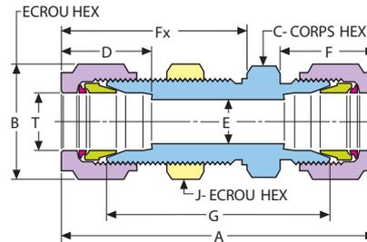
Ce type de traversée permet, après montage sur un châssis métallique, de raccorder à chacune de ses extrémités un tube simple.
