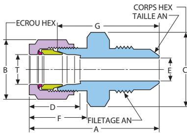
Ce raccord GYROLOK® à filetage AN est prévu pour être assemblé sur un raccord «JIC» monté à l'extrémité d'un tube évasé. L'étanchéité est réalisée par le contact des deux pièces.
