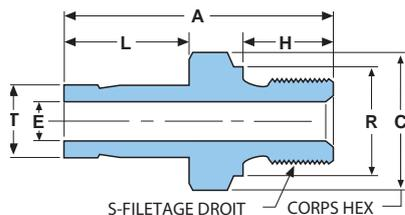
Ce type d'adaptateur permet de convertir une extrémité femelle à taraudage au pas du gaz cylindrique, en une extrémité tube avec empreinte de bague usinée, pour le raccordement d'un raccord à embout GYROLOK®, le joint torique, ou joint plat, assurant l'étanchéité entre les deux pièces.
