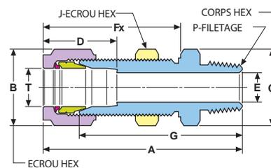
Ce type de traversée permet, après montage sur un châssis métallique, de raccorder, à une extrémité (gauche) un tube simple et à l'autre (droite) un embout femelle taraudé de type NPT.
