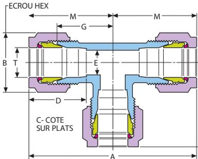
**TTT:** Ce type de Té, à embouts GYROLOK®, permet de relier entre eux, trois tubes de même diamètre.
