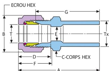
Ce type de composant, permet de convertir une extrémité GYROLOK® par une extrémité lisse d'un diamètre différent (exemple : raccordement d'un tube sur une vanne ou un autre raccord ayant un diamètre différent).
