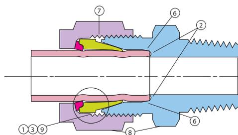
Assemblage et Position des pièces au stade du serrage final
