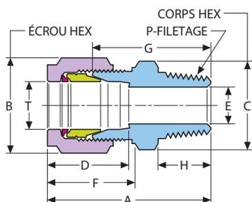
Ce type de raccord permet de convertir une extrémité femelle à tarudage au pas du gaz conique, en un embout GYROLOK® pour le raccordement direct d'un tube simple.
