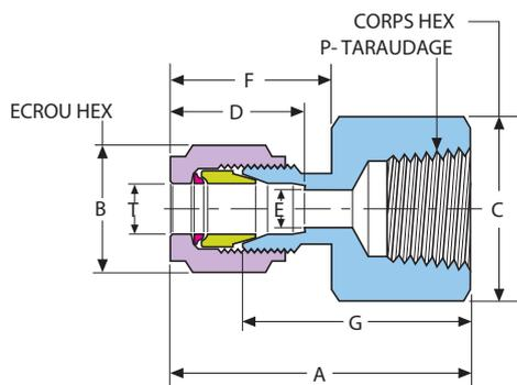
Ce type de connecteur permet de convertir une extrémité mâle à filetage gaz conique en un embout GYROLOK® pour le raccordement direct d'un tube.
