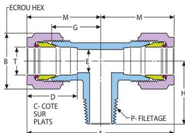
Ce type de té, ayant un piquage avec connexion de type NPT mâle, permet le raccordement de deux tubes aux extrémités GYROLOK® et d'un composant NPT femelle sur le piquage.
