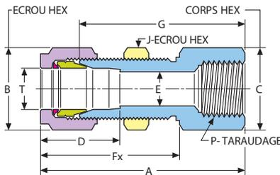
Ce type de traversée permet, après montage sur un châssis métallique, de raccorder, à une extrémité (gauche) un tube simple et à l'autre (droite) un embout mâle fileté de type NPT.
