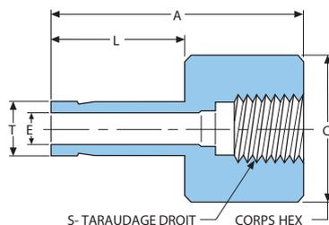
Ce type d'adaptateur à taraudage gaz cylindrique est spécialement conçu pour le montage d'un manomètre. La précision du taraudage et la planéité de la portée de joint de l'adaptateur permettent de garantir l'étanchéité. L'extrémité de type tube, à empreinte de bague usinée, permet le montage d'un raccord à embout GYROLOK®.
