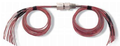
Ces traversées étanches incluent un module haute densité à l'intérieur d'un raccord d'étanchéité. Un tube inox revêtu PTFE, sertissant 12,24, 40 ou 60 conducteurs en cuivre revêtus PTFE ou/et fils de thermocouples, pour réaliser le passage de signaux de thermocouples, sondes à résistance, et autres signaux d'instrumentation basse tension.
